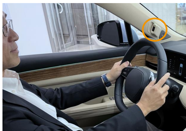
Bilden visar ett exempel på kameraplacering vid ansiktsdetektering.
